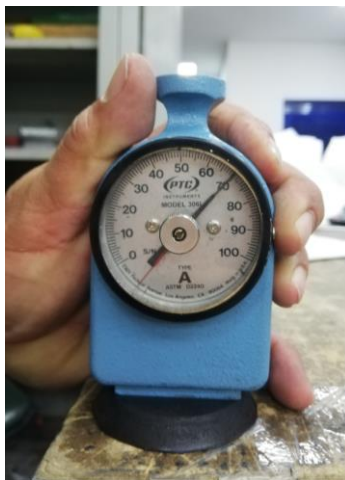
Figura 27. Medición de dureza a elastómero con aplicación en el sellado de placas de intercambiadores de calor usando durómetro Shore A.
