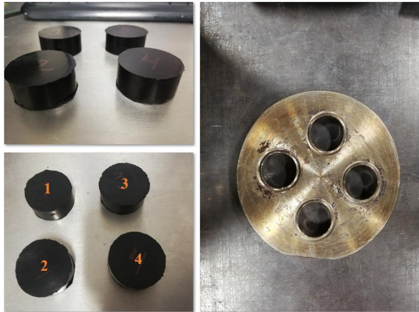
Figura 17. Molde y probetas empleadas en el ensayo de compression set [Elaboración propia]
