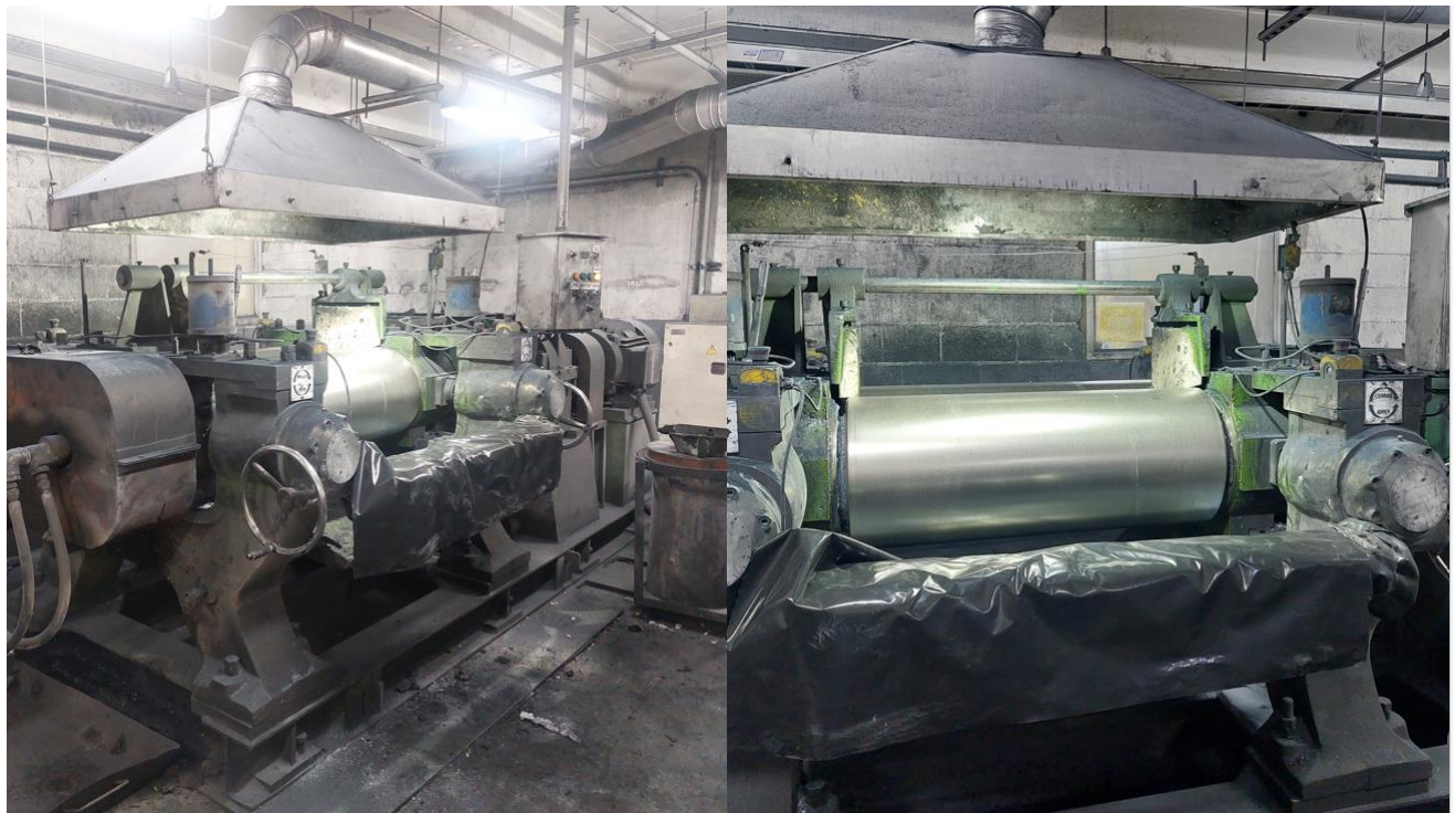
Figura 16 .Molino abierto ubicado en Empaquetaduras y Empaques S.A.
