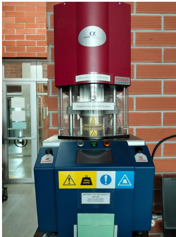
Figura 22. Reómetro de disco móvil Pioneer MDR ubicado en Universidad de Antioquia, Laboratorio de Procesamiento de Materiales Poliméricos.
