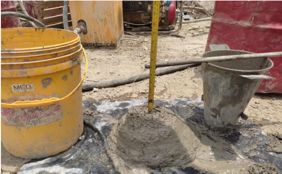
Ilustración 8, Prueba de asentamiento. Fuente: elaboración propia
