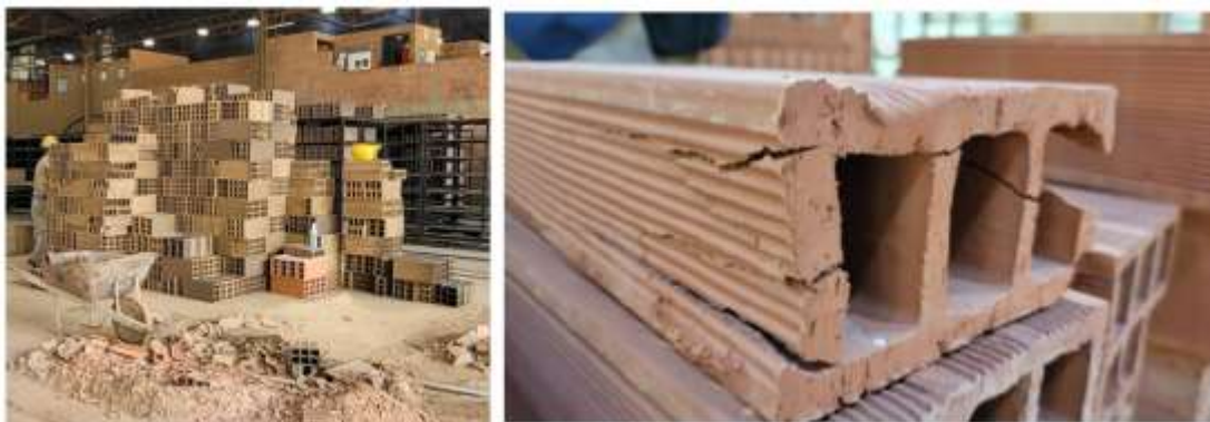
Figura 1. a) Apilamiento de material no conforme b) Defecto de agrietamiento en un ladrillo
