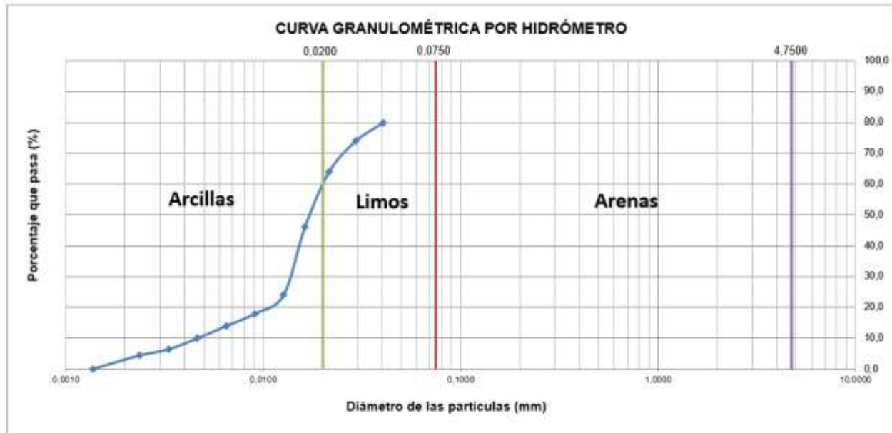
Figura 8. Curva granulométrica por hidrómetro para la arcilla tipo Greda
