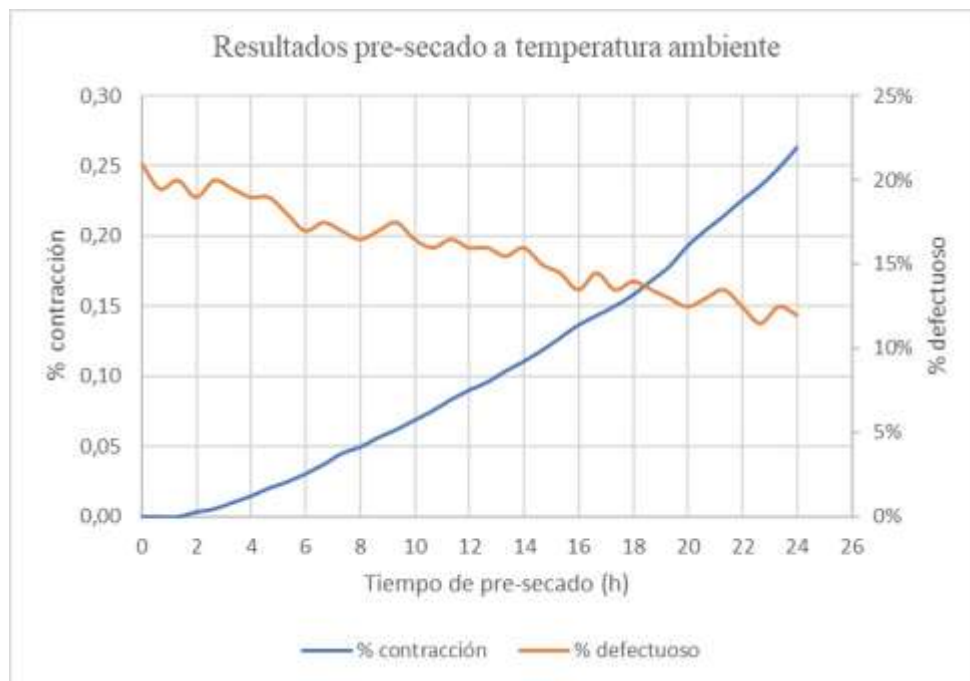
Figura 18. Resultados del pre-secado a temperatura ambiente.
