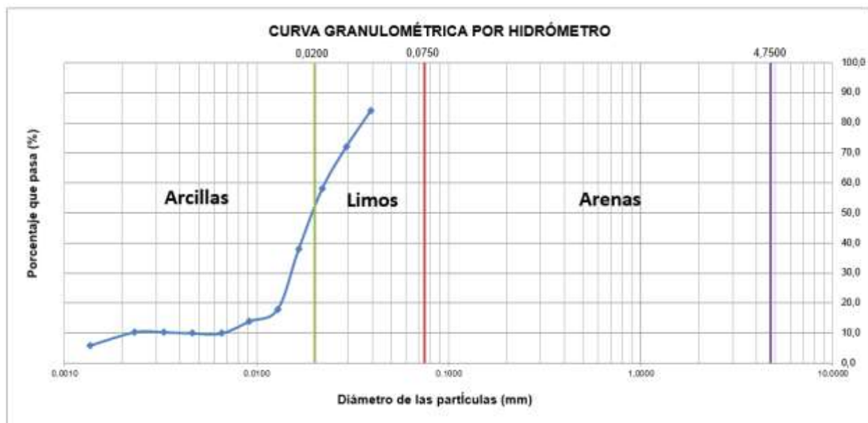
Figura 7. Curva granulométrica por hidrómetro para la arcilla tipo limo
