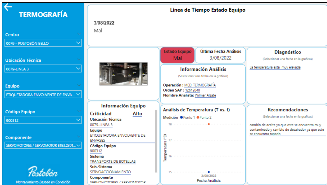
Figura 22. Análisis de Termografía.
