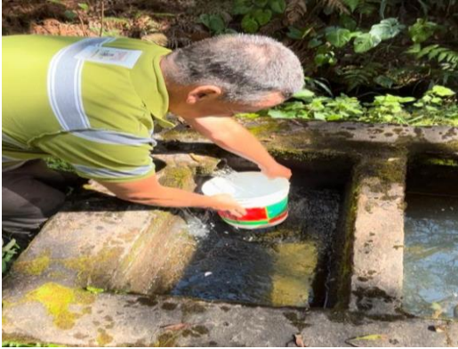
Aforo de caudales de captación.
