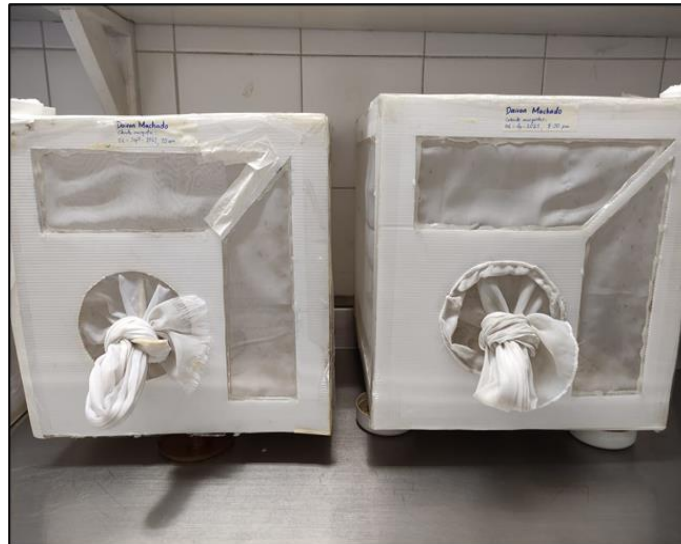
Figura 5. Jaulas para la cría de mosquitos (Foto por Dairon Machado).
