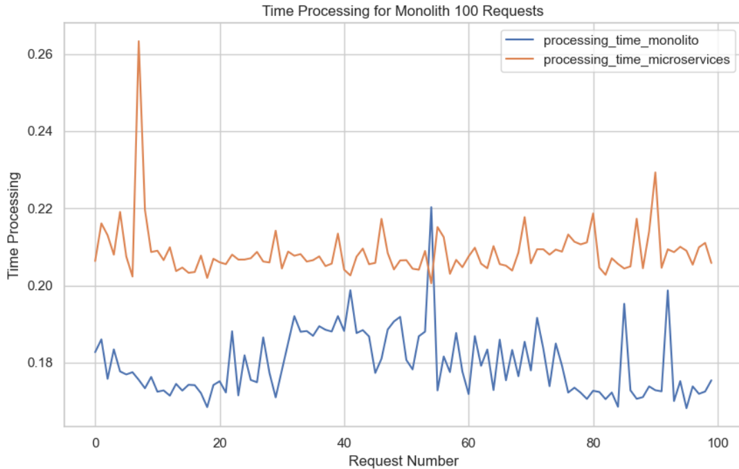
Figura 6-1: Comparación de tiempos de respuesta entre el sistema monolítico y el sistema basado en microservicios.
