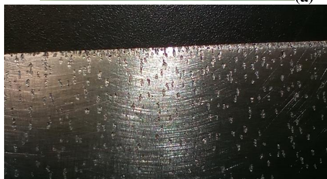
Fig 18. (a) Imagen del electrodo de acero inoxidable 316L siendo polarizado anódicamente en una solución de 0.5M de NaCl. Se puede apreciar la ausencia de formación de gases en la superficie del metal y el desprendimiento de material a modo de bruma color verde producto del efecto corrosivo de los iones \text{Cl}^- . (b) Marcas de corrosión por picadura dejadas en el electrodo luego del ciclo de trabajo descrito en el diseño experimental.
