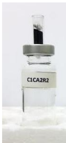
Figura 31. Montaje del captador para las pruebas de adsorción de BTEX en carbón activado.
