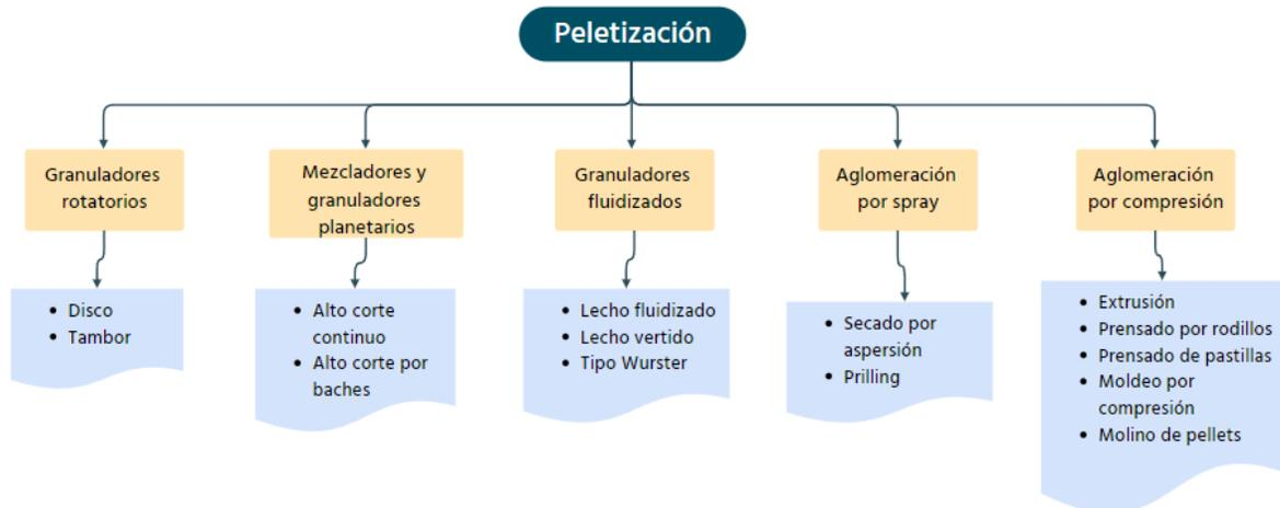
Figura 5. Clasificación de los procesos de peletización.
