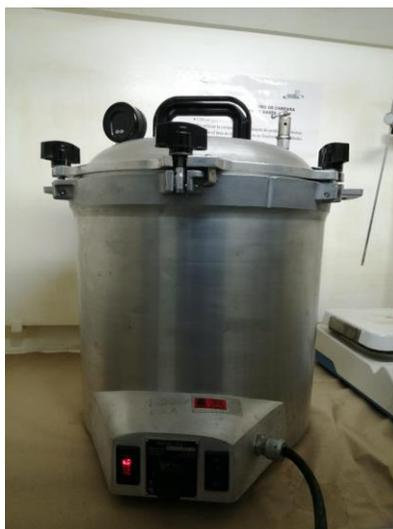
Figura 11. Autoclave para lixiviación básica.
