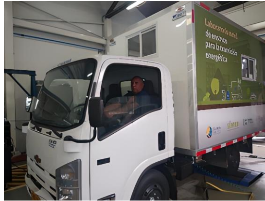
Fig. 24. Fotografía de montaje del vehículo en el dinamómetro de rodillos.
