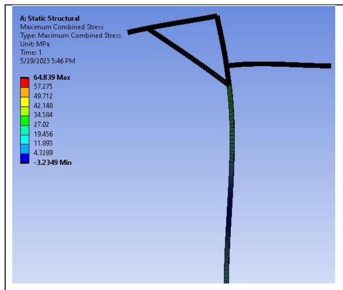
**Ilustración 49** Máximo esfuerzo del soporte 1 y 2.
