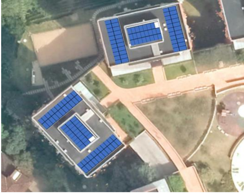
Ilustración 22 Distribución de los paneles solares
