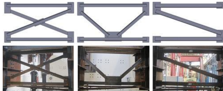
Figura 1. Configuración de arriostramientos transversales.
