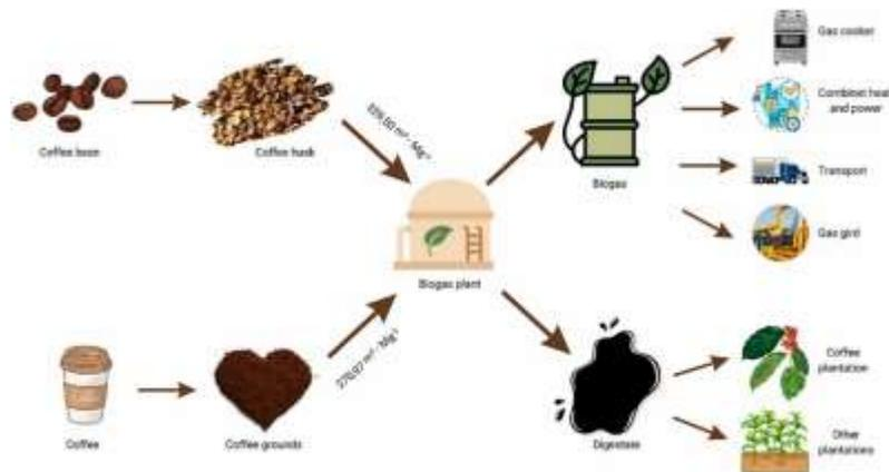
*Figura 4 - Producción de Biogás a partir de la pulpa de café*
