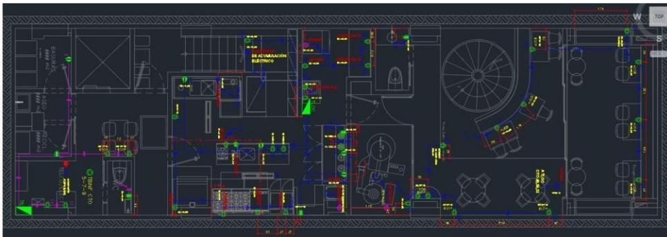
Figura 36 .Plano salidas eléctricas local comercial Sótano 1.
