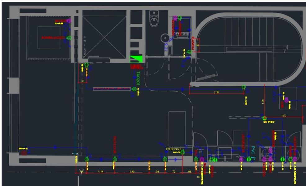
Figura 31. Plano salidas eléctricas cocina sala de entretenimiento y balcón.
