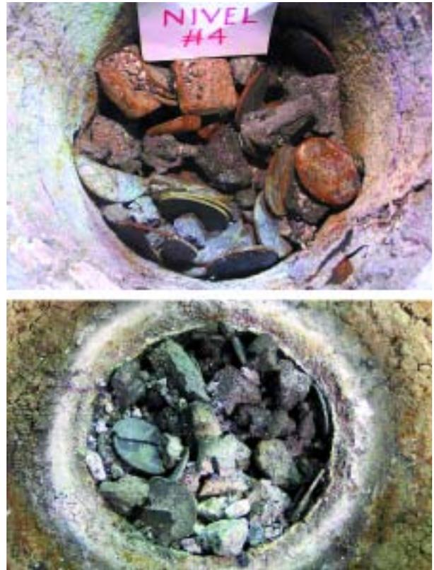
Figura 7. Vista general de las condiciones de los materiales de carga luego del enfriamiento del horno. La primera figura corresponde al Nivel 4, la segunda al Nivel 9.
