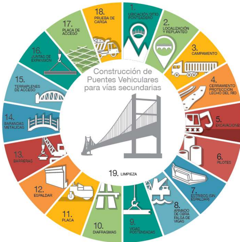
Ilustración 1. Proceso de constructivo de puente.
