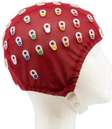
Fig. 1. Gorro para ubicación de 64 electrodos
