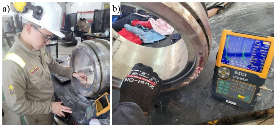
Figura 22. Pruebas de ultrasonido realizadas en SVT.
