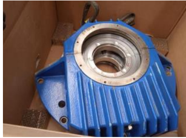
Figura 13. Cojinetes de motor eléctrico (SVT).
