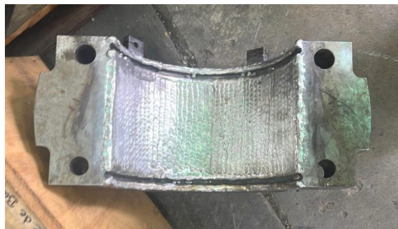
Figura 20. Cojinete recuperado por aporte de soldadura.
