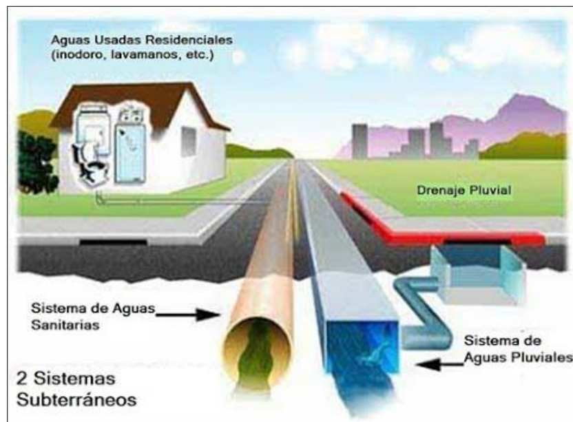
Figura 1. Red sanitaria y pluvial de alcantarillado.
