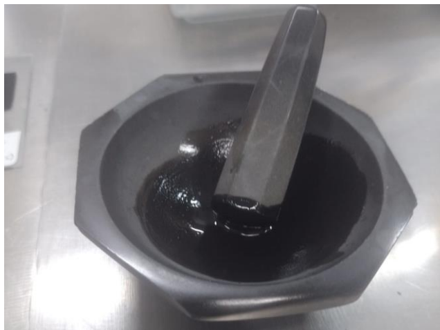
Fig. 17. Mezcla obtenida con 5%GO, 1%PVC y 99%NMP a 25°C.
