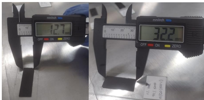
Fig. 20. Medidas de área para las muestras de 5%, 15% y 30% GO en PVC y NMP a 800°C.
