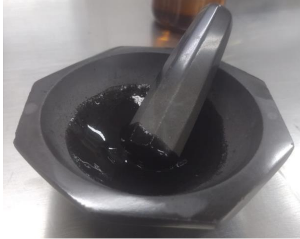
Fig. 11. Mezcla obtenida con 5%GO, 1%CMC y 99%agua a 25°C
