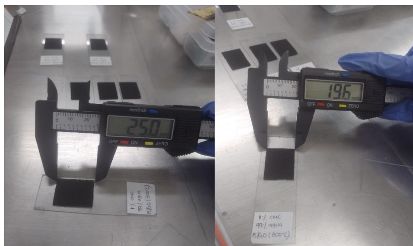
Fig. 16. Medidas de área para las muestras de 15% GO en CMC y agua a 800°C.
