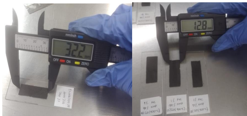
Fig. 21. Medidas de área para las muestras de 5%, 15% y 30% GO en PVC y NMP a 900°C.
