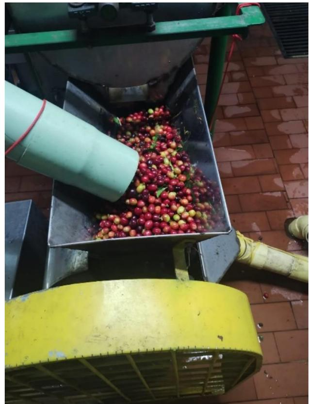
**Figura 25.** Despulpadora.
