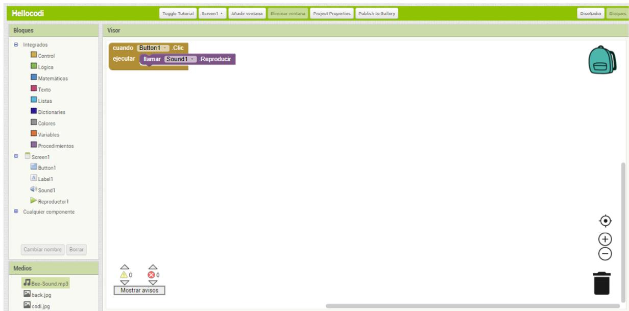
Fig 10. Imagen de la sección de bloques del tutorial Hello Codi, aquí se muestra un bloque de control indicando que cuando se haga Click en la imagen de la abeja se ejecutara el sonido del zumbido.
