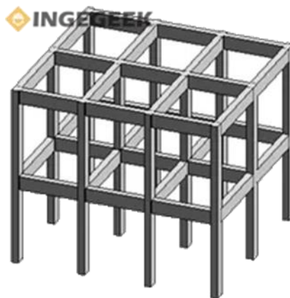
Figura 1. Sistema de pórtico.
