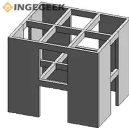
Figura 2. Sistema muros de carga (muro estructural).
