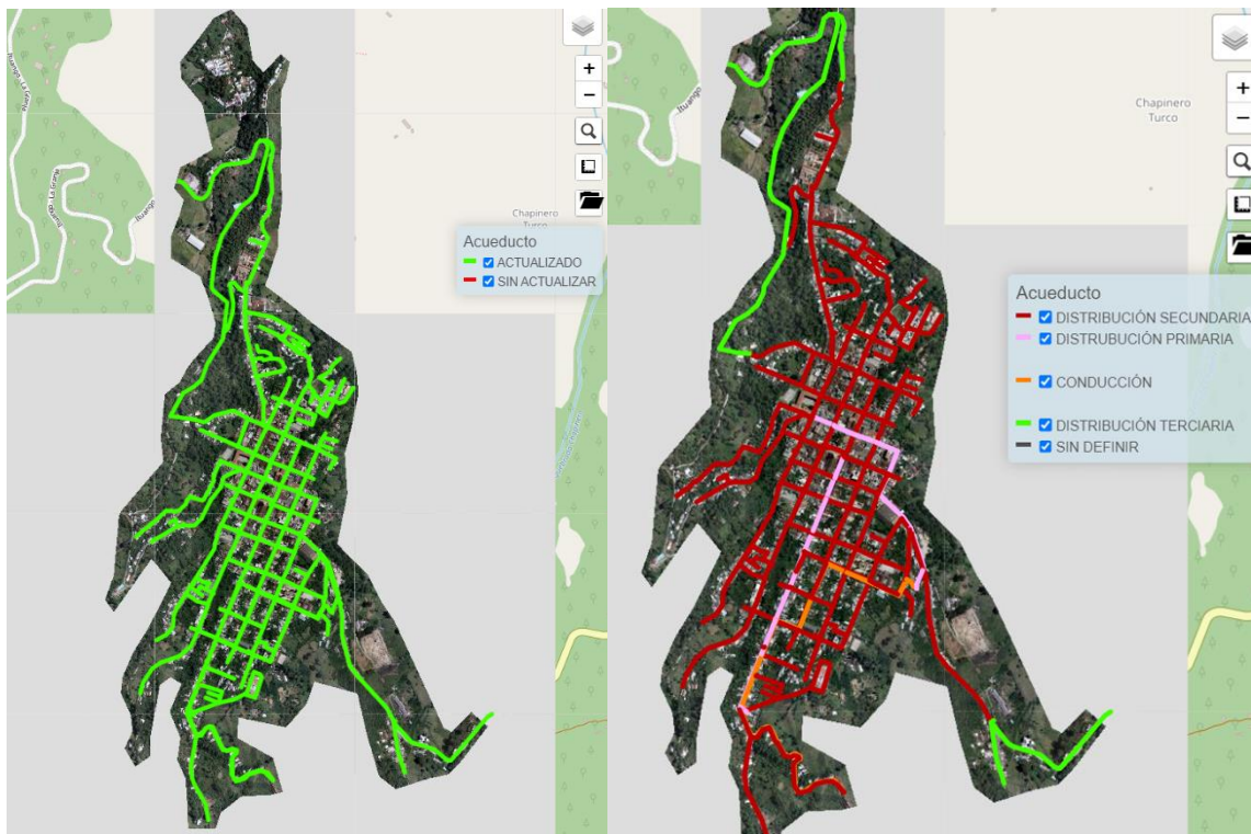
Ilustración 3. Tuberías georreferenciadas de acueducto con información actualizada y visualización de la capa “Tipo de red” en la plataforma Hydrocaz.
