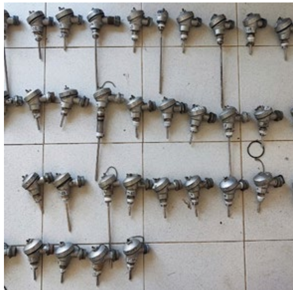
Figura 30 Termopares tipo K instalados en planta
