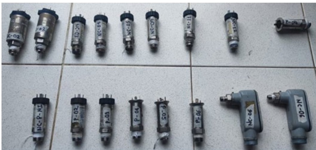
Figura 34 Sensores transmisores de presión instalados en planta
