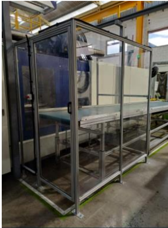
Figura 9. Montaje del sistema de seguridad.
