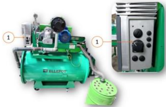
Ilustración 26 Variador de velocidad bomba de vacío EPM large tower.
