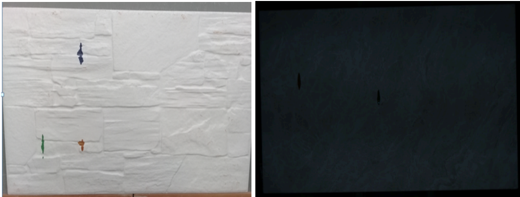
Figura 3. Diferencia de brillo entre imagen de la pieza en proceso (izquierda) vs imagen capturada por el sistema de detección de anomalías (derecha).
