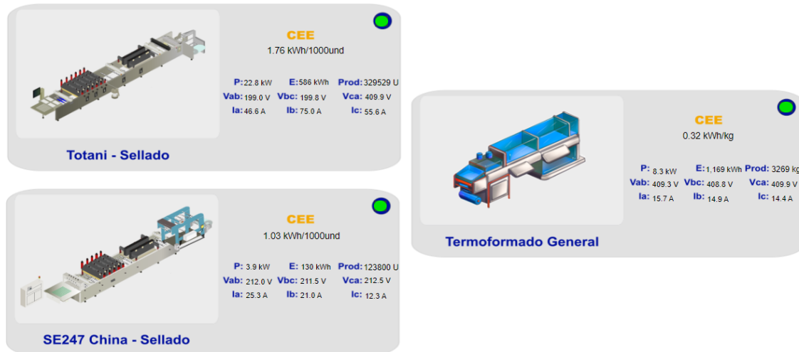
Figura 33. Plantilla para los procesos de sellado y termoformado con cálculos y variables eléctricas.
