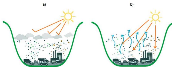
Fuente: Área Metropolitana del Valle de Aburrá Figura 6. a) Representación gráfica de estabilidad atmosférica en el Valle de Aburrá. b) Representación gráfica de inestabilidad atmosférica en el Valle de Aburrá
