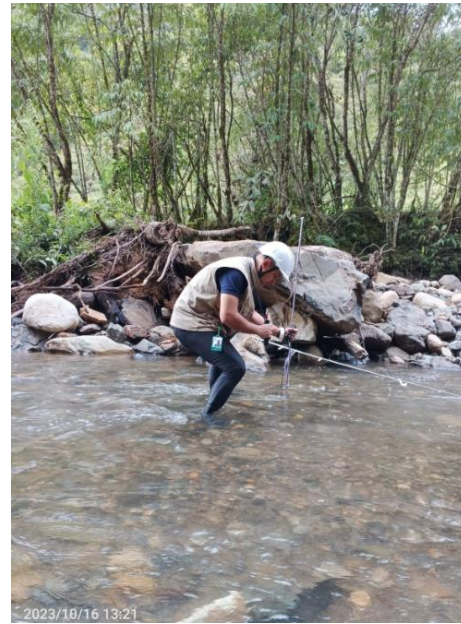
Ilustración 9; Medición revoluciones micromolinet
