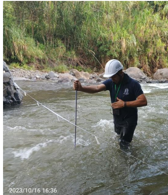
Ilustración 11; Medición revoluciones micromolinet
