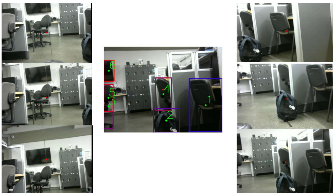
Fig 23. En el centro las inferencias de los objetos, imágenes a los lados movimiento del gimbal para enfocar los objetos detectados.
