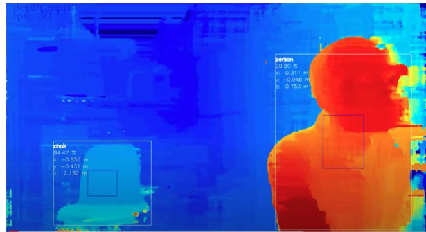
Fig 2. Imagen obtenida del sensor de profundidad de la cámara oak-d lite. Ésta tecnología permite la medición de distancia utilizando 2 cámaras o lentes separados a una distancia conocida. Es utilizada como un método de bajo costo para sistemas embebidos. Al usarse en conjunto con redes convolucionales se puede obtener la distancia de objetos que se consideren importantes.
