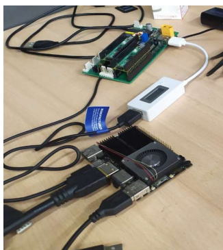
Fig 17. Sistema embebido del proyecto Autosail. Con el cual se conectará la cámara el LiDAR y el gimbal.
