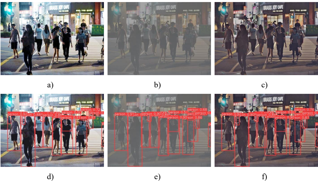
Nota. a) procesamiento con HE. b) Procesamiento con CLAHE. c) Procesamiento con MSRRCR. d) Detección de personas en imagen procesada con HE- e) Detección de personas en imagen procesada con CLAHE. f) Detección de personas en imagen procesada con MSRRCR
