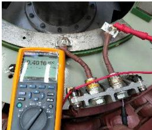
Fig. 8. Prueba de continuidad de diodos.
