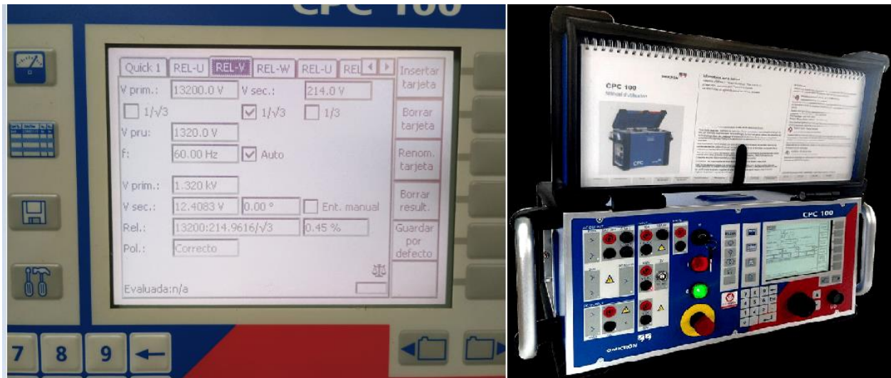
Fig. 11. Prueba de relación de transformación.
