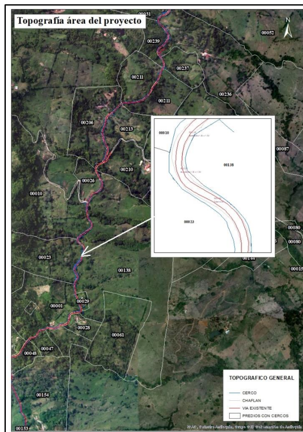
Figura 1. Levantamiento topográfico tramo de vía Támesis-Jericó. Elaboración propia a partir de información suministrada por el área de Gestión predial de la Gobernación de Antioquia.
