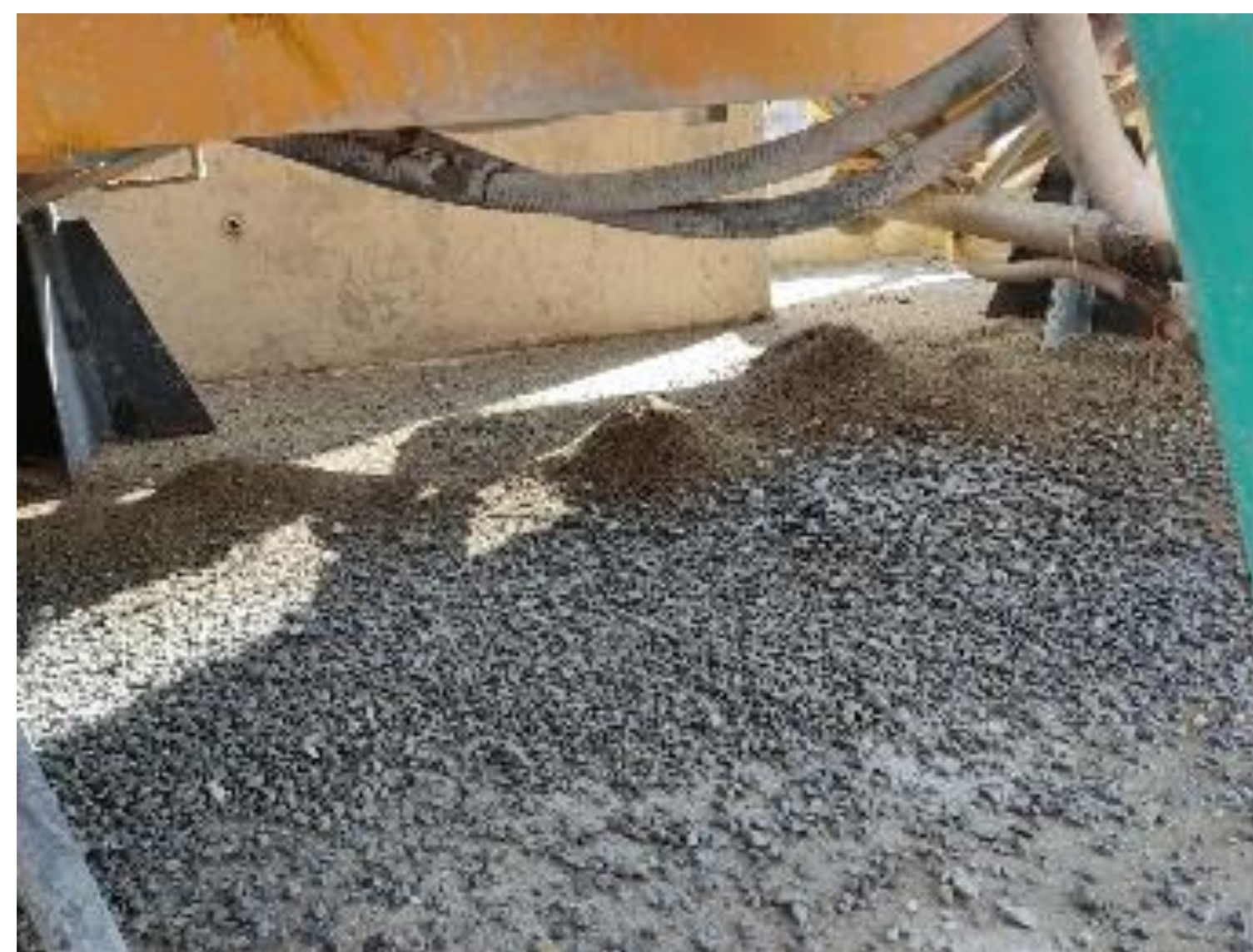
Agregados que caen al suelo en la planta durante la producción de concreto
