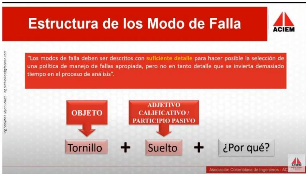
Figura 3. Estructura de los modos de falla (López, 2022).
