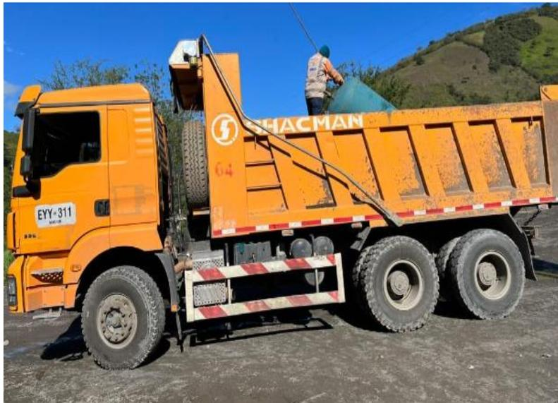
Figura 2. Volquetas doble troque con capacidad para (12 y 15) m<sup>3</sup> (Imagen Propia).
