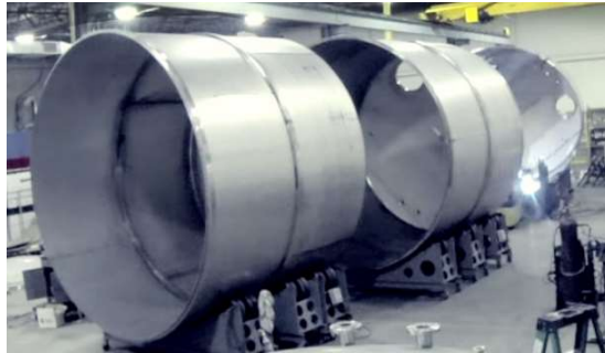
Figura 2. Fabricación de un tanque en acero inoxidable.
