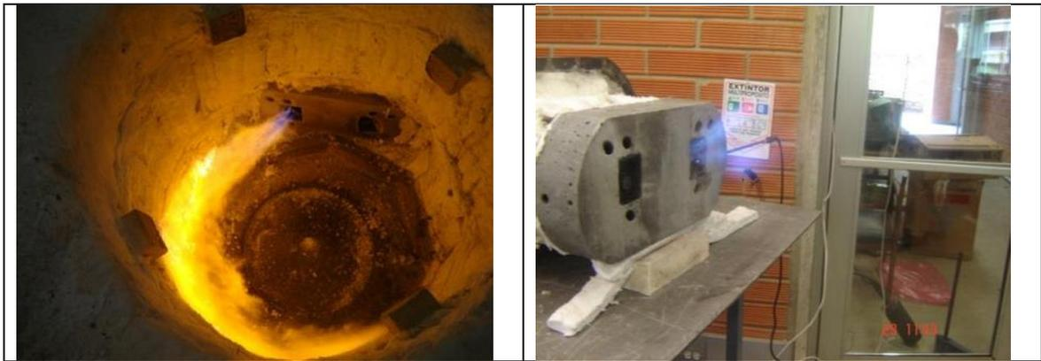
Figura 25. Imagen de cómo se forma la llama al interior de la cámara de combustión sin el crisol (izquierda). Quemador operando descargando a la atmósfera (derecha). Adaptado de [41].
