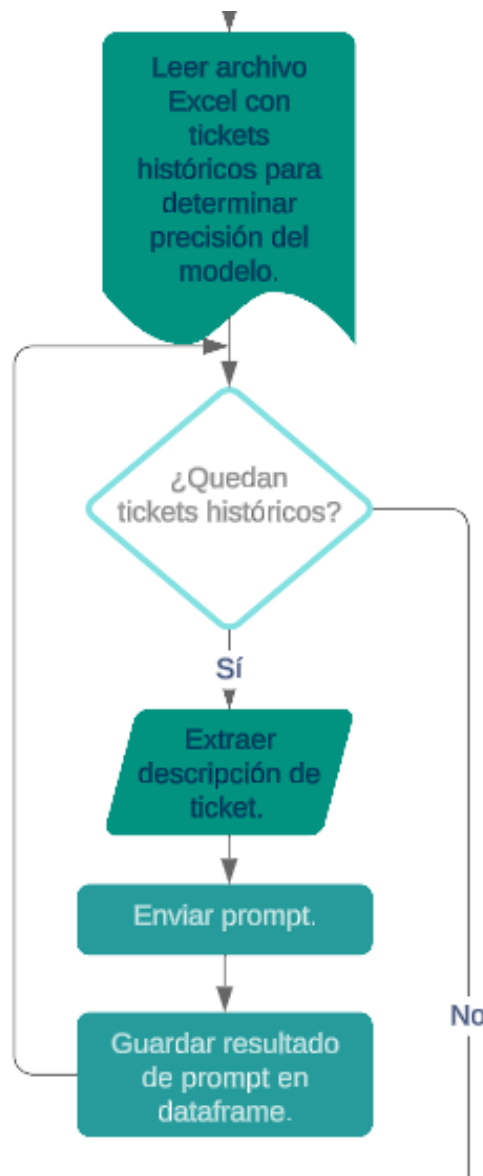
Figura 13. Diagrama de flujo para bloque de creación de archivo de prueba de modelo AI en código de creación de modelo de la figura 11.
