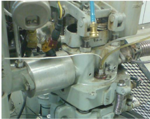
Sistema de inyección e inyector
