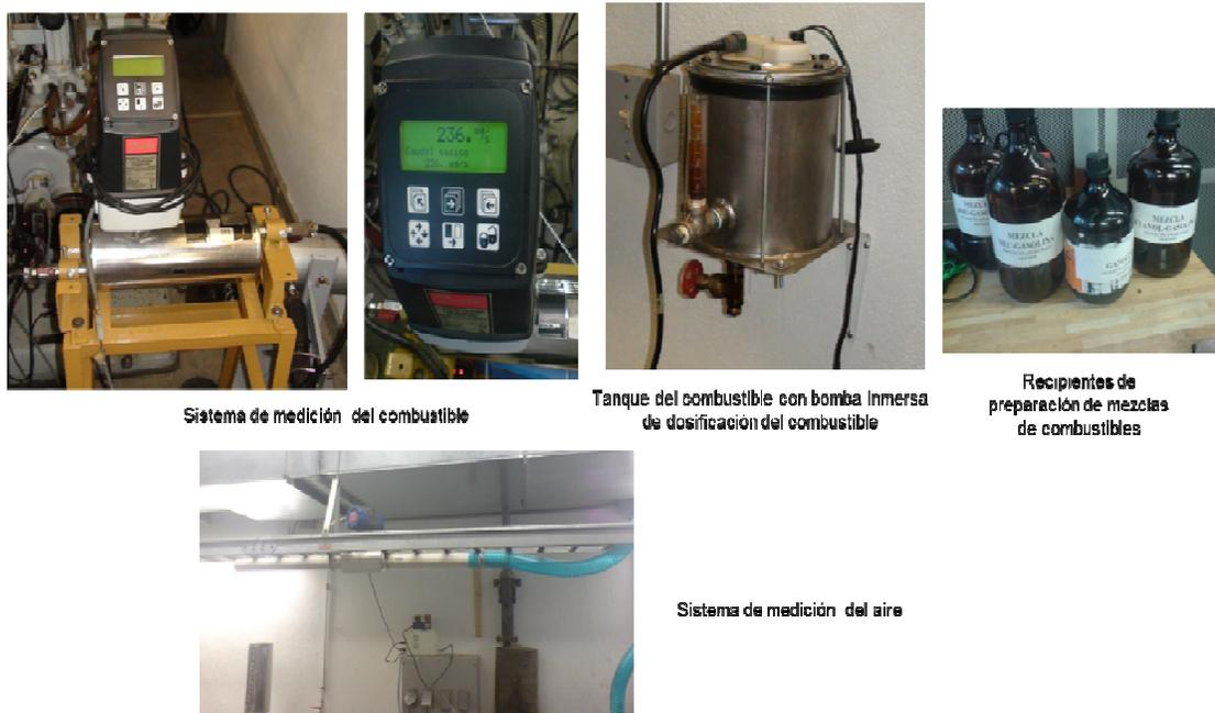
**Figura A.5.** Medición del combustible y del aire
