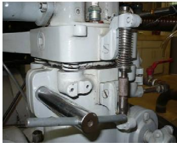
Micrómetro utilizado para graduar la relación de compresión.
