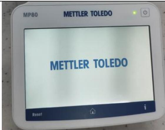
Se enciende el ventilador y el indicador LED verde, posteriormente la pantalla se oscurece levemente y detiene el ventilador
