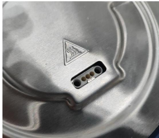
Figura 6. Señal de seguridad de superficie caliente y ranuras para capilares.
