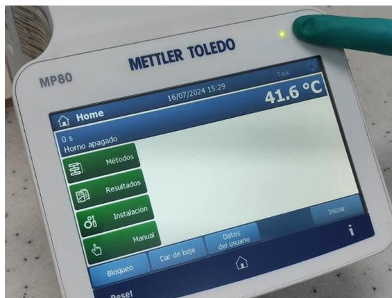
Se presiona el botón de Encendido/Apagado durante 4 segundos.
