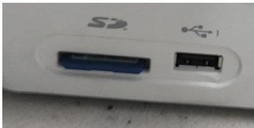
Figura 7. Puertos de tarjeta SD y memoria USB tipo A.
