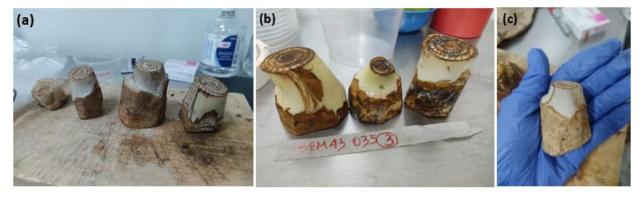
Una vez finalizado el proceso anteriormente descrito, se realizó un lavado superficial al material con una solución de agua corriente y jabón neutro a razón de 5 cm<sup>3</sup>/L durante 5 min a 100 RPM. Pasados los 5 min, se enjuagó con agua corriente hasta eliminar completamente la espuma. Posteriormente, se realizó un segundo lavado adicionando una solución de agua corriente con yodo
