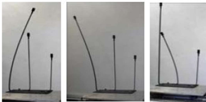
Ilustración 1 Periodos de vibración péndulos simples (Domínguez, 2014)
