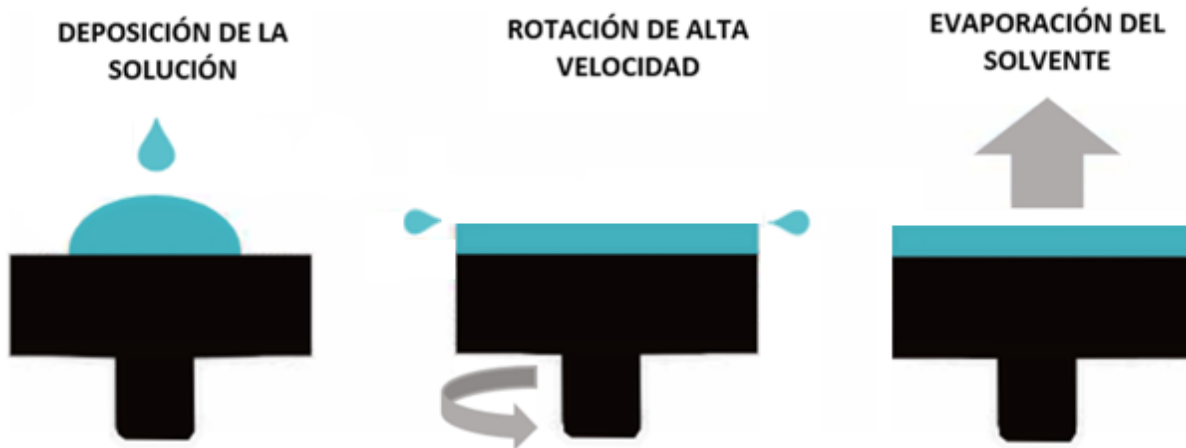
Figura 6. Proceso de spin coating. Figura adaptada de [36].
