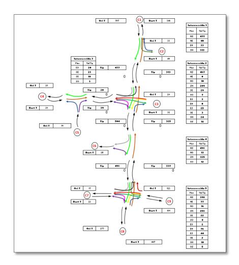
Estos centroides son los que van a contener la información de entrada y salida de vehículos. Se crean utilizando la herramienta de centroides vista con anterioridad. Una vez creado el centroide, debe conectarse a la red vial con la herramienta de unir secciones. Con esta herramienta, conectamos la vía al centroide: si es de salida, unimos la vía al centroide; y si es de entrada, se conecta desde el centroide hacia la vía.
