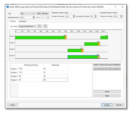
Nota: Es importante tener en cuenta si el semáforo tiene la misma programación durante todo el día o si varía según la hora, para asegurarnos de usar la configuración correcta según el horario de modelación. Si hay más de una intersección semaforizada, estas deben unirse. Para ello, seleccionamos todas las intersecciones, hacemos clic derecho y seleccionamos Juntar.
