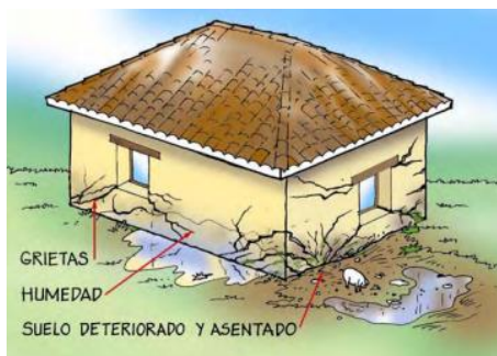
Figura 2. Física – Se destaca la humedad
