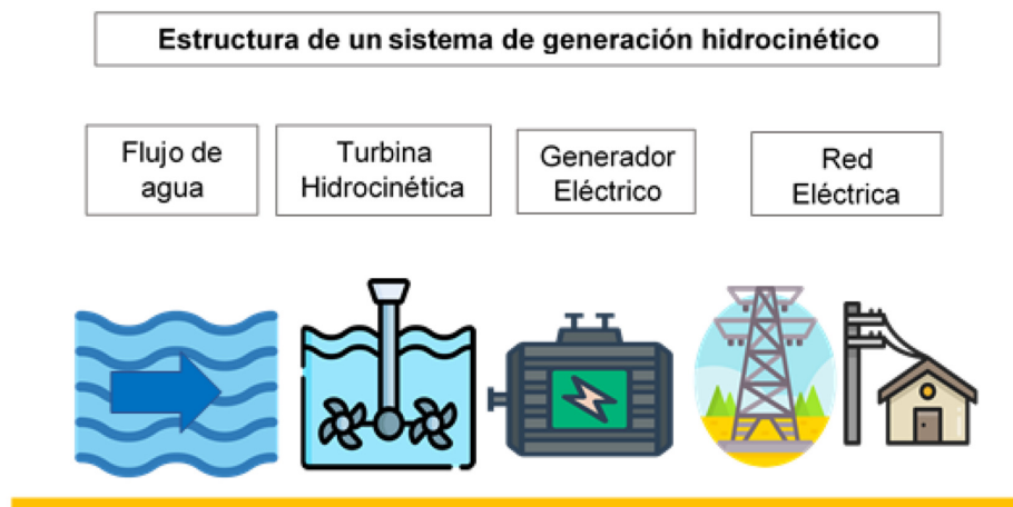
Figura 4: Estructura de un sistema hidrocínético de generación. Elaboración propia basado en W.I Ibrahim [19].
